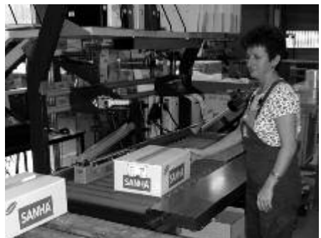
Bild 10: Vermeidung von Hebe- und Trageaktionen durch höhenverstellbare Arbeitstische und Rollbänder
